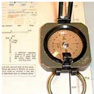
Pour orienter approximativement la carte, on peut simplement aligner l'aiguille de la boussole avec le bord de la carte.
